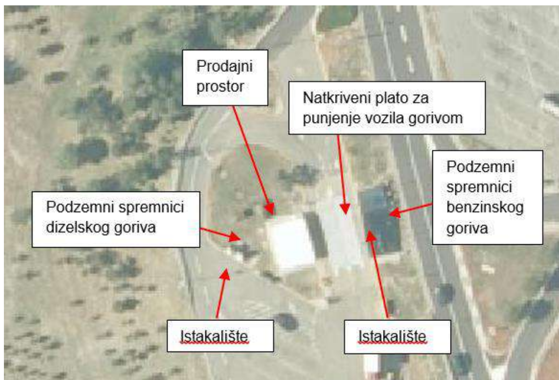
Slika 14. Mikrolokacija BP Učka s označenim glavnim dijelovima benzinske postaje
